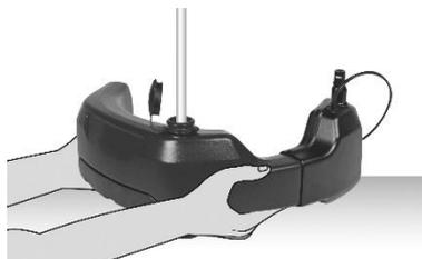
2. Posizionare il serbatoio dell'acqua sul telaio, chiudere il coperchio e in seguito posizionare la testa del motore. Importante: il serbatoio dell'acqua del win-i non viene riempito d'acqua.
